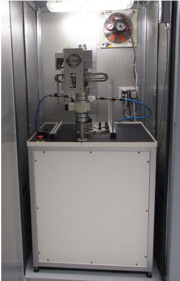
Resonanzpulsator RUMUL-GIGAFORTE 50 kN © Fraunhofer IWS Dresden
