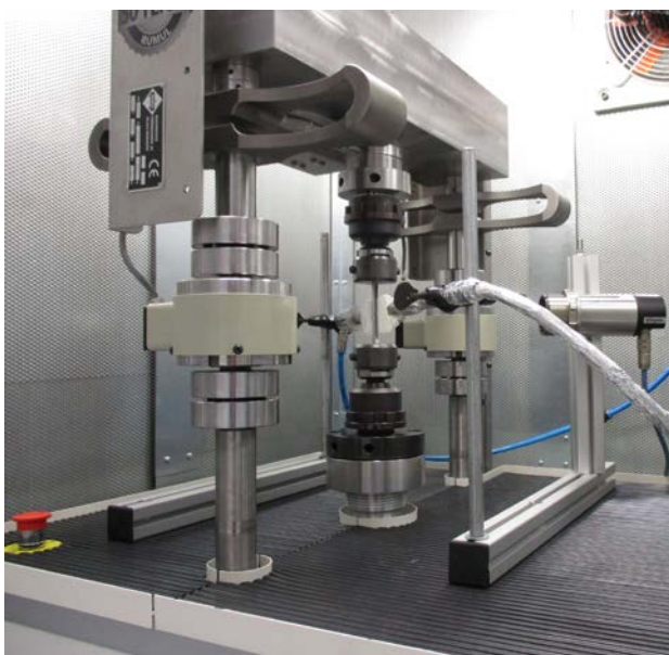
Gekerbte Stahlprobe während eines Zugschwingtests © Fraunhofer IWS Dresden
